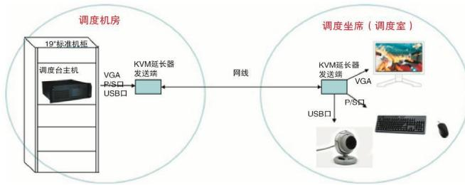
为满足调度台更高稳定性使用要求，我们将产品进一步优化：将调度台主机和屏幕、摄像头、键鼠等外设一起，统一部署在调度员办公桌，从而可简化设备部署工作，减少走线。传统的屏幕式调度台主机由于体积大，噪音高，不适合直接部署在调度室内，而广哈通信推出的ET300小型化调度台，采用了无风扇自然散热设计，无噪音，并且主机体积大大缩小，可直接部署在调度桌底，从而避免了引入KVM延伸器带来的问题。见下图。
