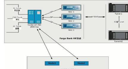
本次项目实施完成了60多套Unify Open Xpert Turret (操作台),并接入域网络,通过MLC和SIP PBX对接,完成语音通信业务调试。
